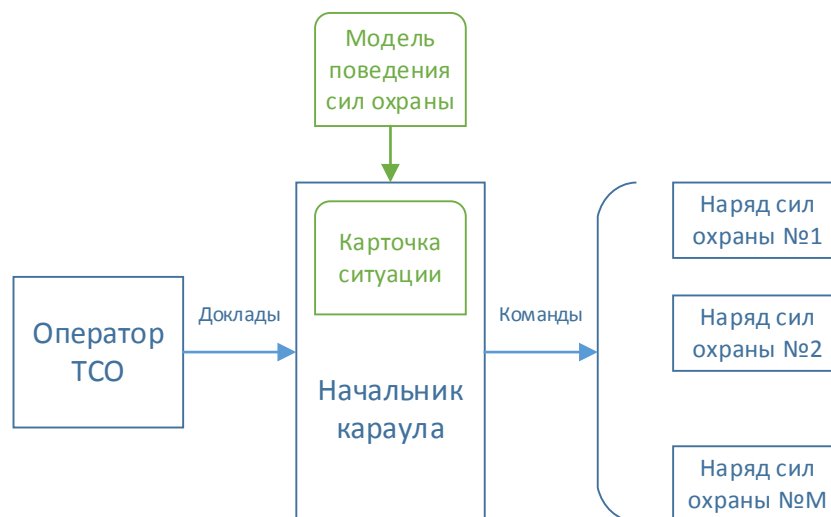
Рисунок 4.3 – структура модели начальника караула в системе имитационного моделирования.
